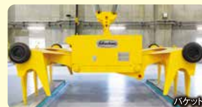
ごみを移動させたり、混ぜたりする作業は、ごみクレーン・バケットで行います。1度に約3.5トンのごみを持ち上げることができます。
