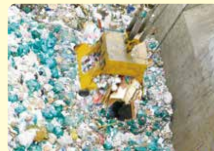
ごみを移動させたり、混ぜたりする作業は、ごみクレーン・バケットで行います。1度に約3.5トンのごみを持ち上げることができます。
