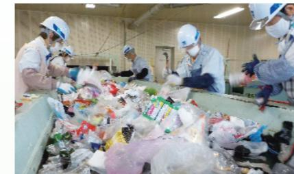
左ページ「処理の流れ」の4項に記載しました、収集されたごみは混入不適物を取り除くため、手選別室に運ばれます。
